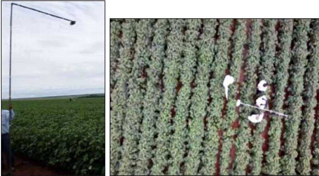
FIGURA 2. Câmera multiespectral Tetracam ADC lite instalada em suporte a 4 m e posição relativa acima de duas fileiras da cultura no momento da tomada de uma parcela.
