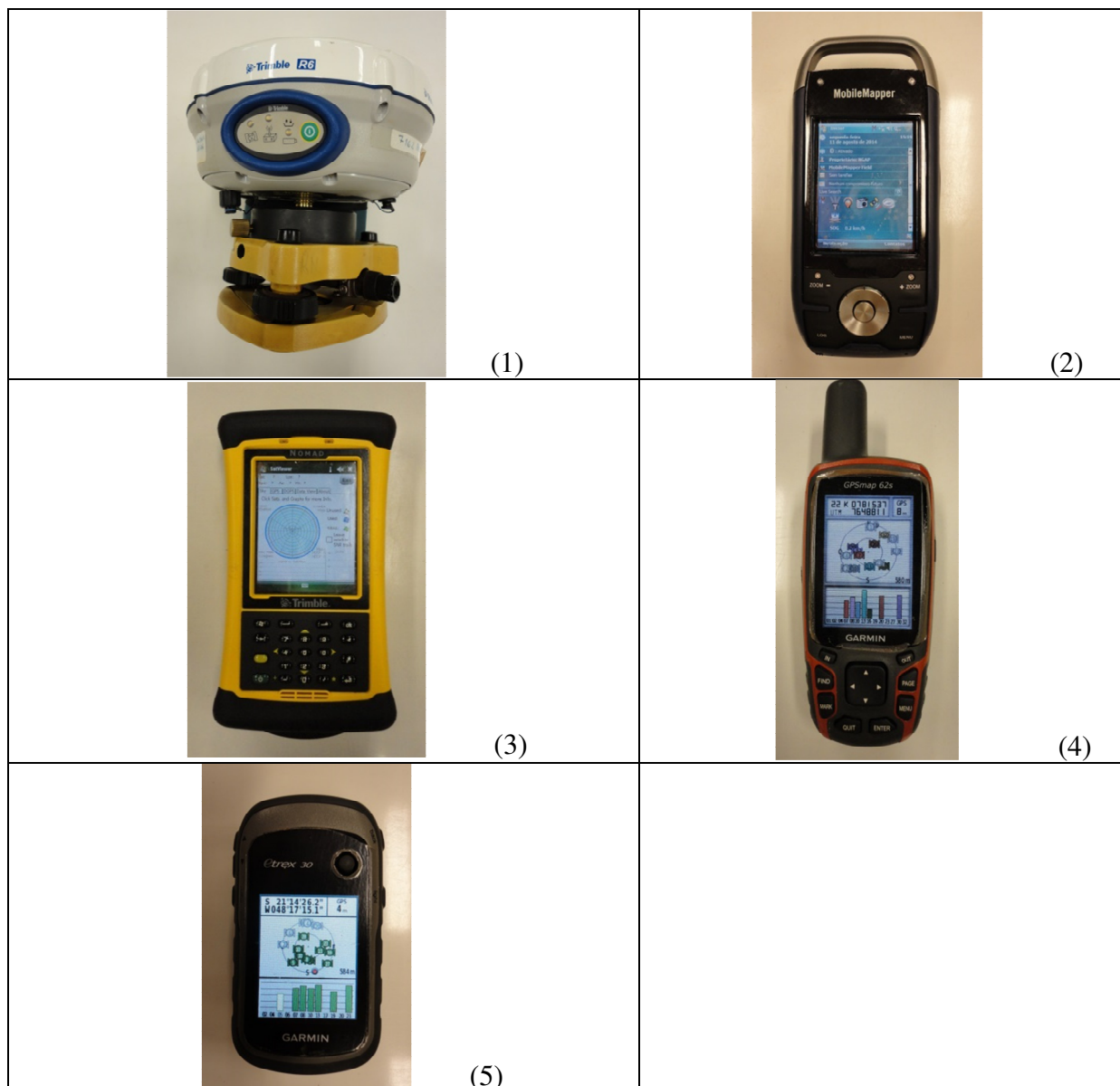
Figura 1: Equipamentos utilizados na coleta de dados de campo. Da esquerda para a direita e de cima para baixo, receptor Trimble R6 (1), receptor Mobile Mapper 6 (2), Receptor Trimble GPS Nomad (3), receptor Garmin GPSMap62 (4) e receptor Garmin Etrex30 (5).
